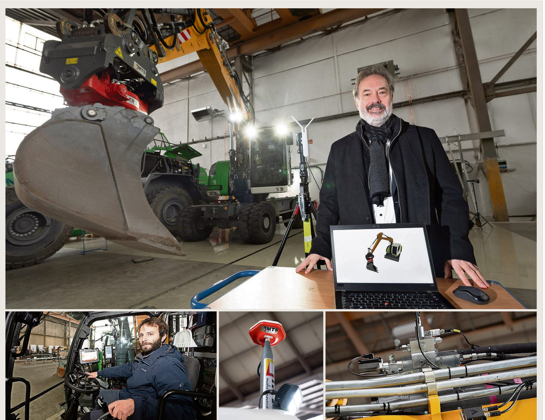
Bagger mal zwei: Auf dem Computer lässt Jürgen Weber (o.) den digitalen Zwilling der Baumaschine entstehen. Noch sitzt zwar Benjamin Beck (u. l.) im Führerhaus, aber mit Hilfe modernster Technik arbeitet der Bagger schon bald selbst. Notwendig sind dafür unter anderem spezielle Antennen (u. M.) und vernetzte Steuerventile (u. r.). Fotos: Rene Meinig
